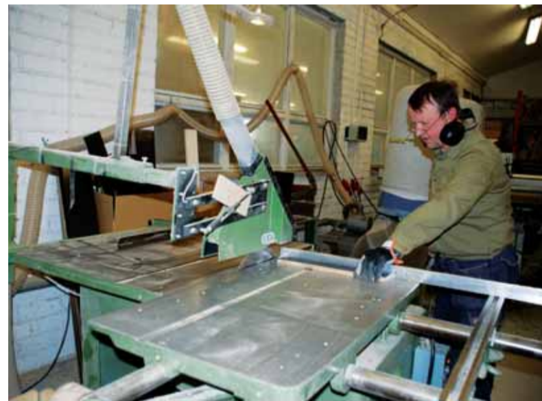
Nii löigatakse vineeri kohvrite tarbeks, kus transportitakse eriti tundlikke aparate – mõõteriistu näiteks.
